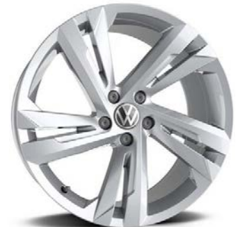
Serie per R-Line Cerchio in lega VALENCIA 8,5 J x 19 con pneumatici AirStop® 235/45 R19
