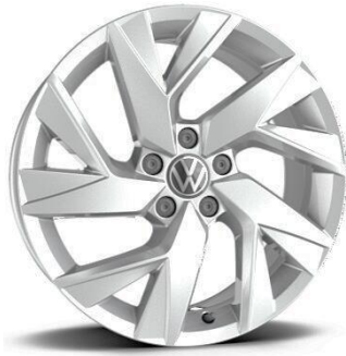
Serie per Elegance / Optional per Life Cerchio in lega FRANKFURT 7J x 18 con pneumatici AirStop® 235/55 R18
